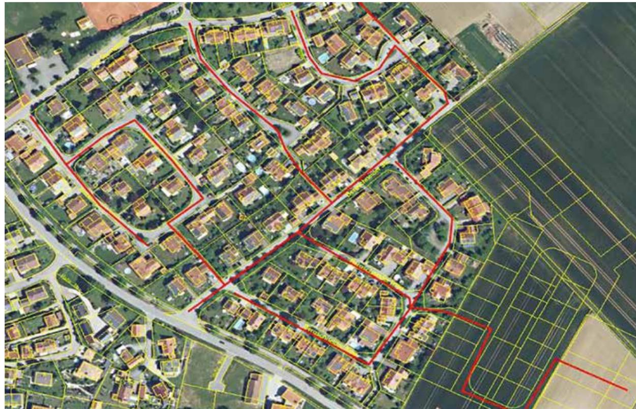
möglicher Streckenverlauf der Nahwärmeversorgung
